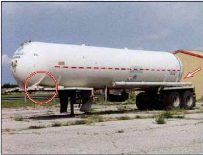
Imagen 26.60 Los MC-331 generalmente tienen dispositivos de cierre detrás de la cabina, del lado del conductor, y en la parte trasera. Cortesía de Rich Mahaney.
