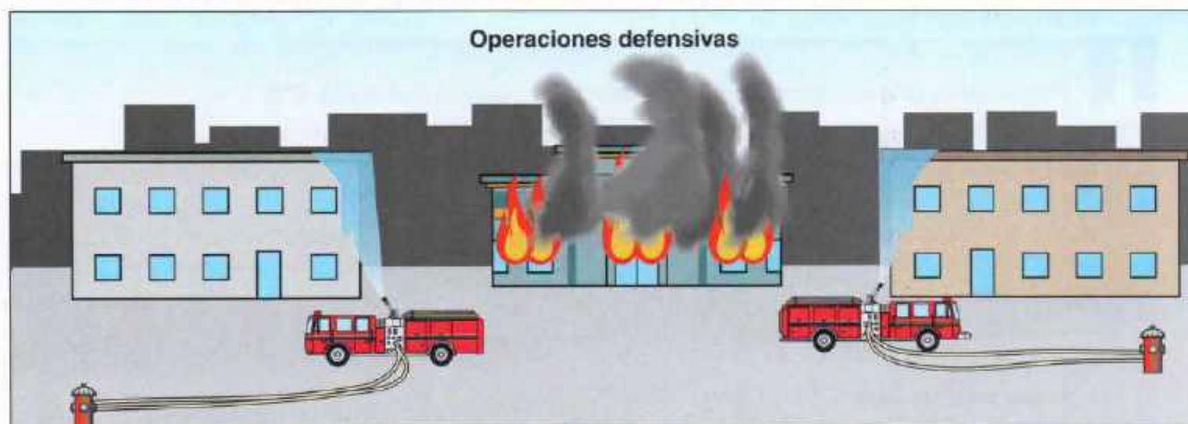
Imagen 19.10 La edificación en llamas en esta ilustración se está dejando quemar mientras que los esfuerzos de extinción tratan de salvar las edificaciones a ambos lados.
