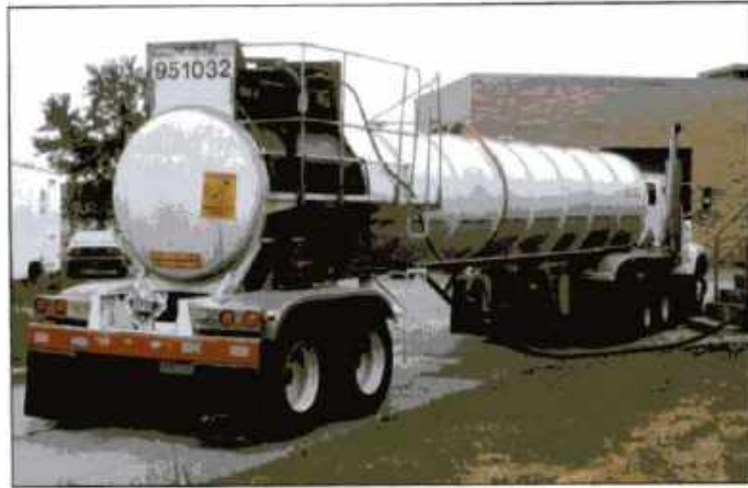
Imagen 24.141 Este autotanque de líquido corrosivo tiene un área de descarga pintada o recubierta con un color diferente. Cortesía de Rich Mahaney.
