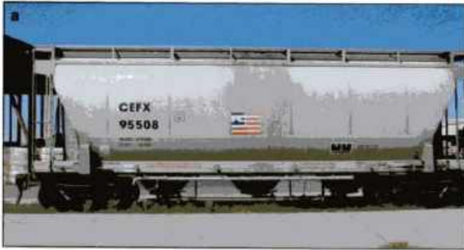
Imagen 24.158 a y b Los carros tolva de descarga neumática transportan nitrato de amonio para fertilizantes, soda cáustica seca y otros sólidos. Cortesía de Rich Mahaney.
