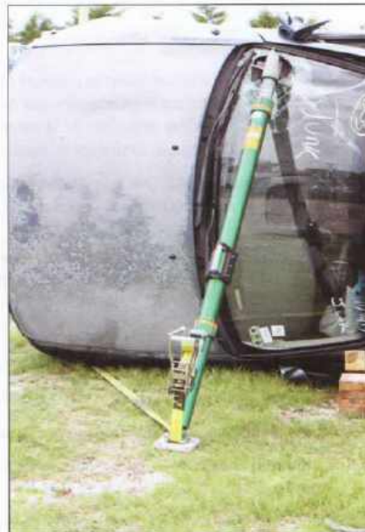
Imagen 17.45 Parte de un sistema de contrafuerte tensado que estabiliza un vehículo de costado.
