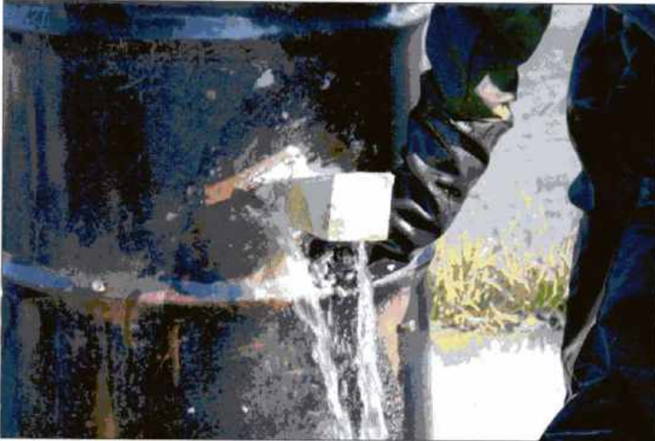
Imagen 25.40 El control de fugas intenta mantener un material en su contenedor original.
