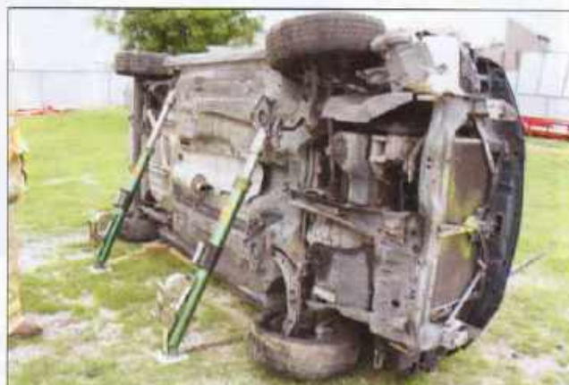
Imagen 17.20 Un sistema de contrafuerte tensado que se utiliza para estabilizar un vehículo que descansa sobre su costado.
