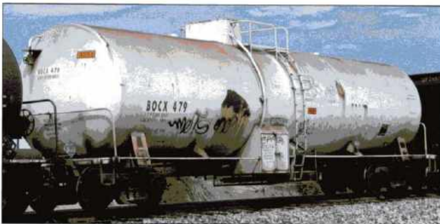
Imagen 24.127 Los carrotanques de líquidos criogénicos soportan bajas presiones y pueden ser reconocidos por los gabinetes a nivel del suelo, en el costado o en el extremo posterior del carrotanque. Cortesía de Rich Mahaney.
