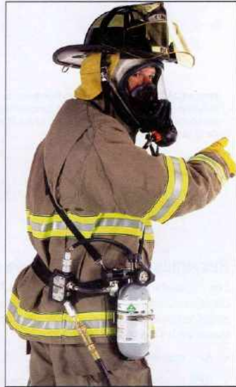
Imagen 26.3 Un típico SAR con EBSS. El EBSS debería proveer por lo menos 5 minutos de aire en caso de emergencia, lo que es suficiente para escapar del área peligrosa hacia una atmósfera segura. Cortesía de MSA.
