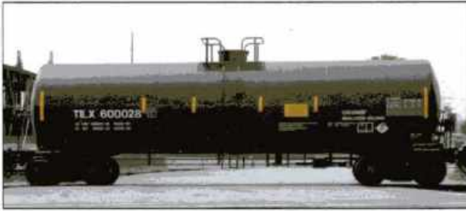
Imagen 24.109 Los carrotanques presurizados transportan gases venenosos, inflamables y no inflamables. Cortesía de Rich Mahaney.
