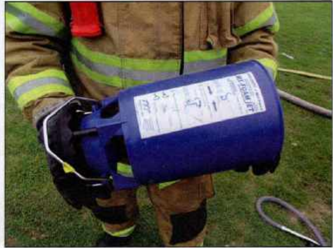
Imágenes 26.55 a y b Las boquillas con aspiración de aire, airean la espuma de mejor manera creando un mayor índice de expansión.
