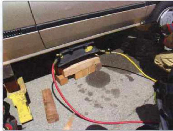
Imagen 17.26 Una bolsa de elevación de alta presión usada para levantar un carro.
