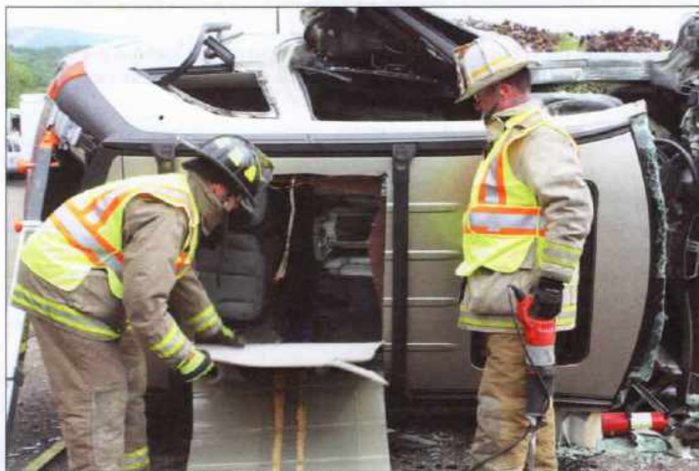
Imagen 17.51 Rescatistas plegando el techo de un vehículo que descansa sobre un costado.
