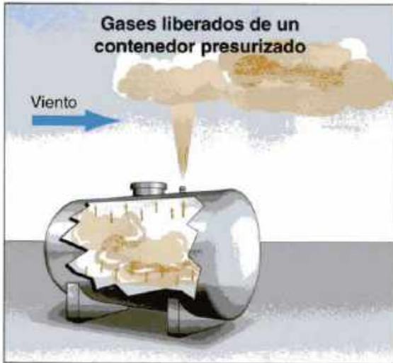
Imagen 24.95 Un gas se expandirá rápidamente cuando es liberado al ambiente debido a una rotura o falla del contenedor.
