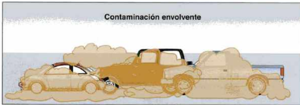
Imagen 24.60 La contaminación envolvente se produce cuando un producto se dispersa, formando una zona de peligro.
