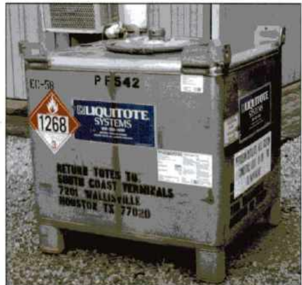
Imagen 24.170 Los RIBC pueden ser cajas o recipientes cuadrados o rectangulares y pueden transportar líquidos, fertilizantes, solventes u otros productos químicos. Generalmente están diseñados para apilarse. Cortesía de Rich Mahaney.
