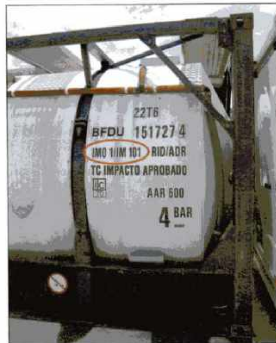
Imagen 24.92 La información de especificación lo identifica como un contenedor intermodal IMO 1/IM 101.
