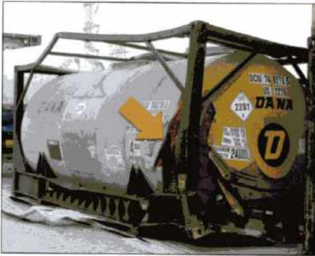
Imagen 24.58 La costura soldada se ha separado en este contenedor intermodal. Cortesía de Rich Mahaney.
