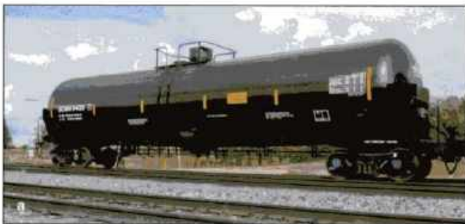
Imagen 24.148 a y b Los carrotanques inflamables de alto peligro (HHFT) a menudo transportan etanol y petróleo crudo. Cuando están involucrados en accidentes, pueden liberar sus productos, entrar en ignición y romperse violentamente. Cortesía de Rich Mahaney.
