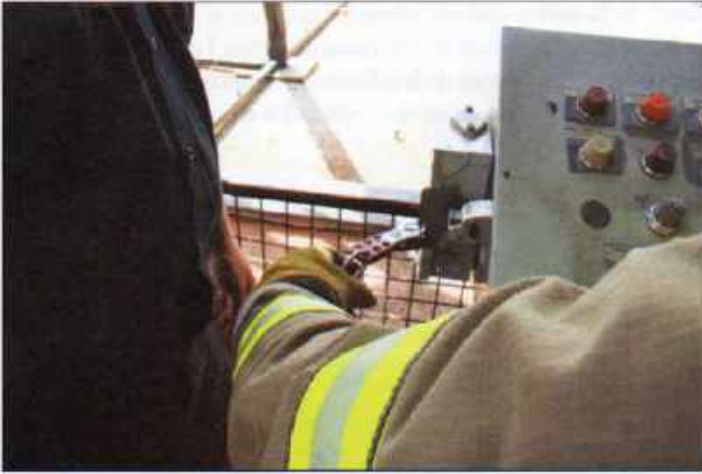
Imagen 17.11 Se debería usar un dispositivo de bloqueo/etiquetado cuando se corta la energía.
