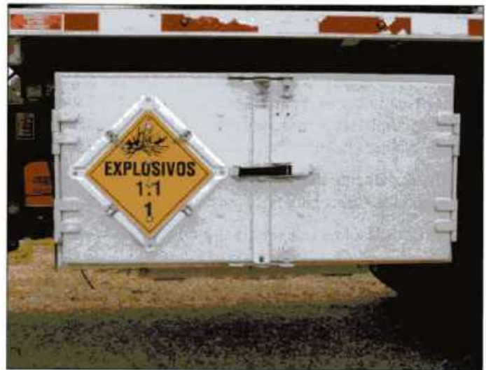
Imagen 24.183 Ciertos contenedores y áreas de almacenamiento están diseñados específicamente para explosivos. Cortesía de David Alexander, Texas Commission on Fire Protection.
