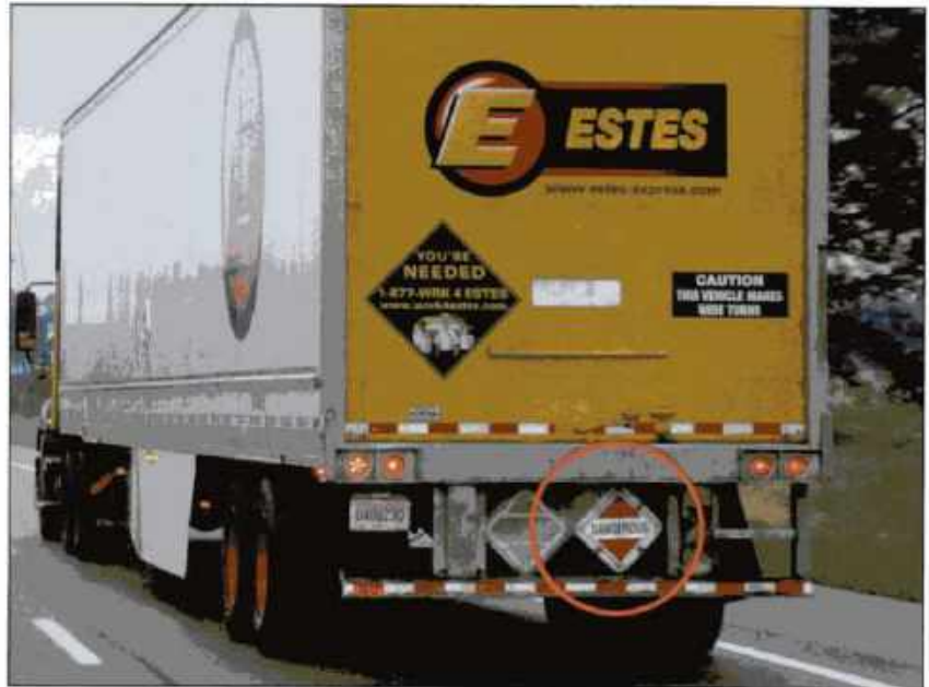
Imagen 24.176 La placa PELIGROSO indica que el vehículo contiene embalajes no granel con dos o más categorías de materiales peligrosos que requieren placas diferentes. Cortesía de Rich Mahaney
