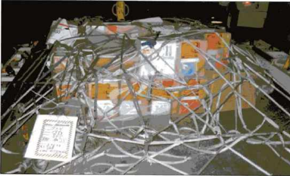
Imagen 24.167 Los dispositivos de carga unitaria (ULD) se utilizan para consolidar la carga aérea en una sola unidad transportable. Los ULD que contengan materiales peligrosos deben estar apropiadamente rotulados y etiquetados. Cortesía de John Deyman.
