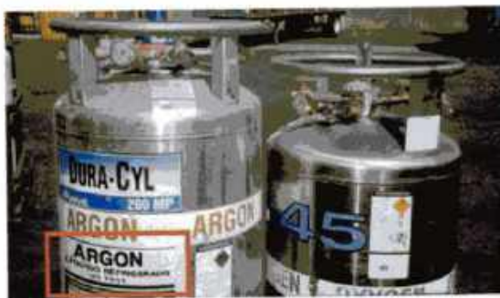
Imagen 24.120 Los contenedores criogénicos se utilizan para almacenar gases licuados, como dióxido de carbono, nitrógeno, oxígeno y argón.
