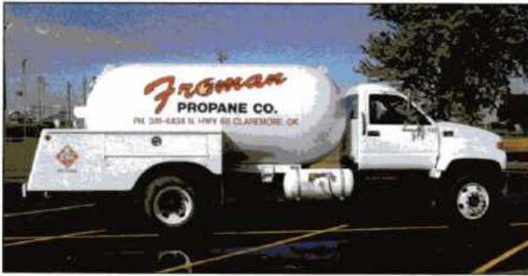
Imagen 24.102 Los tanques Bobtail son utilizados para distribuir propano y otros productos.
