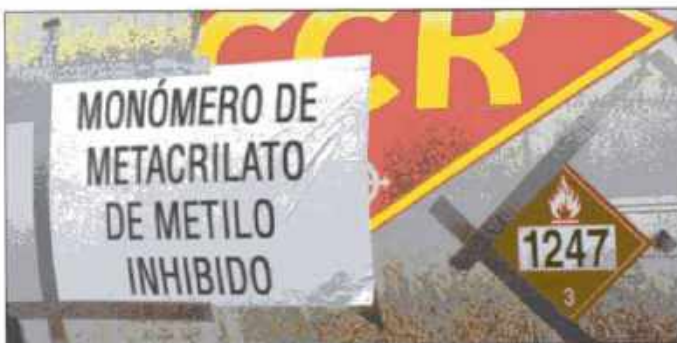
Imagen 24.212 La ortografía exacta del nombre de una sustancia química es importante cuando se utiliza la Guía de respuesta a emergencias. Los errores ortográficos pueden causar acciones inapropiadas y potencialmente peligrosas. Cortesía de Rich Mahaney.
