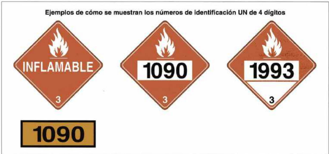
Imagen 24.171 Ejemplos de cómo se mostrarán los números de las Naciones Unidas en los contenedores a granel (como camiones tanques de carga y carrotanques) y ciertos contenedores no a granel.
