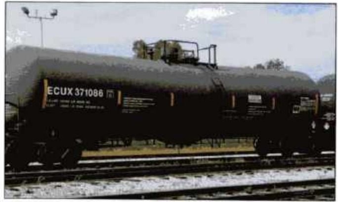
Imagen 24.143 Los carrotanques de baja presión transportan líquidos y sólidos peligrosos y no peligrosos.
