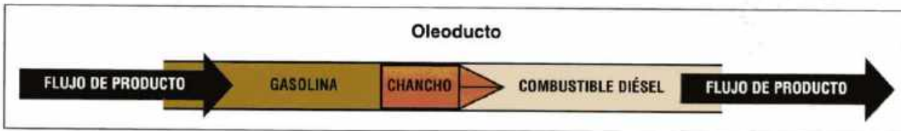
Imagen 24.160 Una tubería individual puede transportar más de un tipo de producto separado por un raspador o un chanco de tubería ( pipeline pig ).
