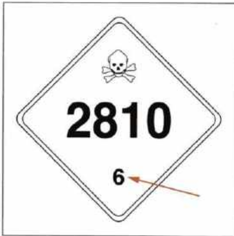
Imagen 24.175 La esquina inferior de una placa muestra la clase de peligro o el número de división correspondiente a la clase de peligro primario o secundario de un material.
