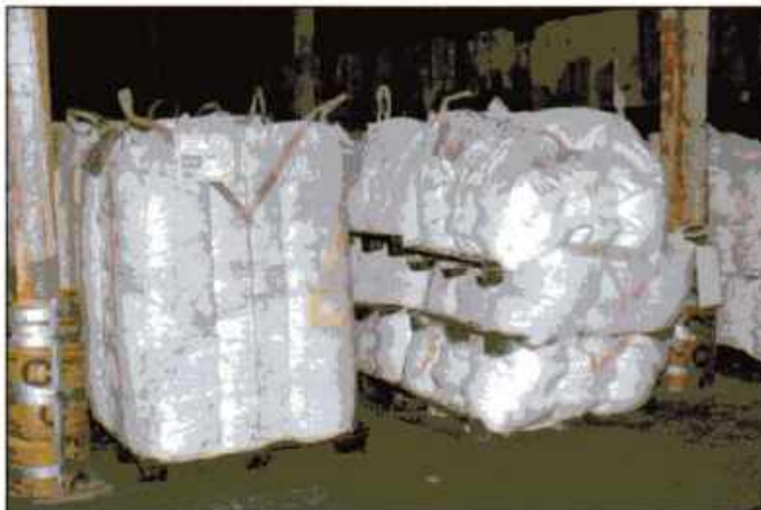
Imagen 24.169 Un único contenedor de carga intermedia flexible puede transportar el equivalente de cuatro a cinco tambores de 55 gal (200 L). Cortesía de Rich Mahaney.
