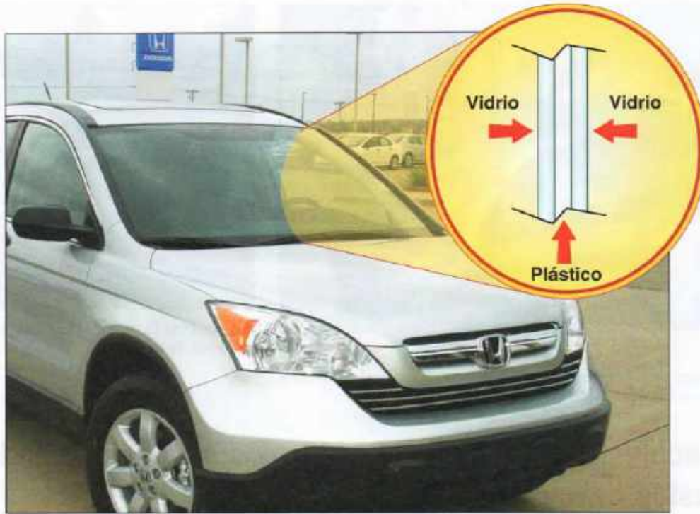
Imagen 17.32 Los automóviles y camiones están equipados con parabrisas de vidrio de seguridad laminado.
