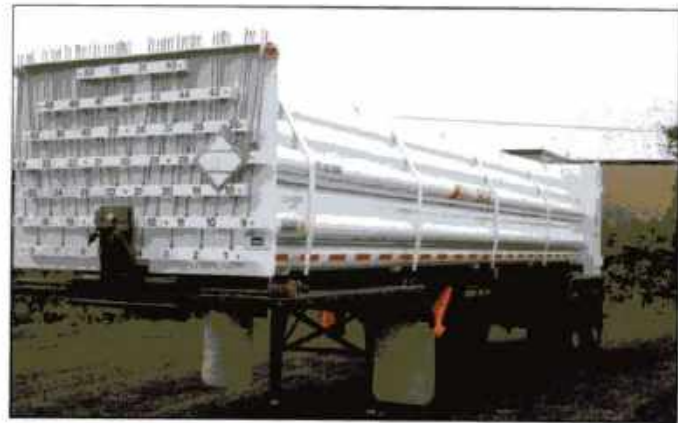
Imagen 24.106 Los números en este remolque para cilindros de gas comprimido corresponden al dispositivo de alivio de presión para cada cilindro. Cortesía de Barry Lindley.
