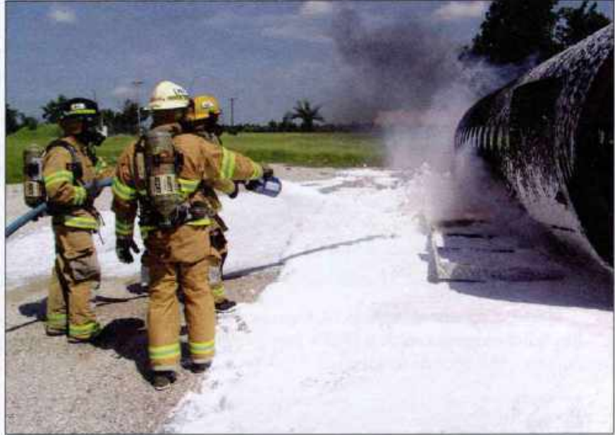
Imagen 26.49 Las espumas AFFF no son efectivas sobre materiales miscibles en agua, como alcoholes, ésteres y cetonas.
