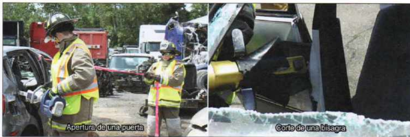
Imagen 17.49 Se pueden usar herramientas operadas hidráulicamente para abrir una puerta o cortar las bisagras de una puerta.
