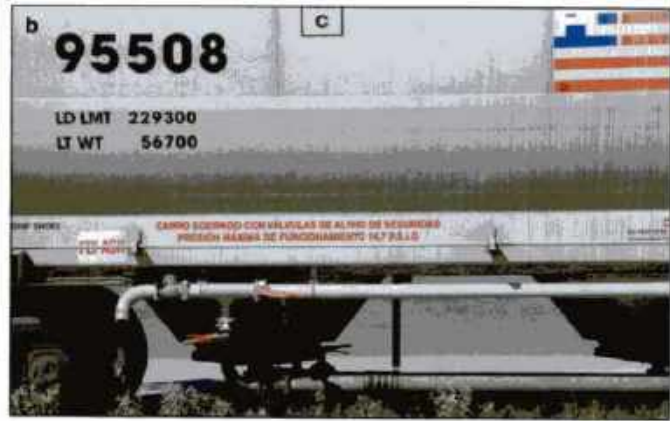
Imagen 24.158 a y b Los carros tolva de descarga neumática transportan nitrato de amonio para fertilizantes, soda cáustica seca y otros sólidos. Cortesía de Rich Mahaney.
