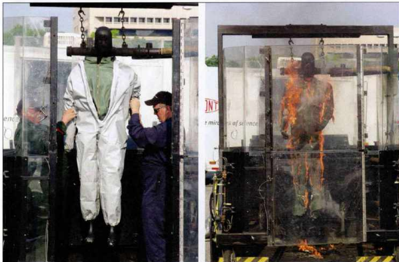
Imagen 26.12 La ropa de protección química no siempre es resistente a las llamas; después de haber estado sometida a un breve fognazo, esta sigue ardiendo y se funde.
