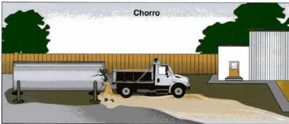
Imagen 24.66 Un chorro es arrastrado por la gravedad, siguiendo los contornos topográficos de la superficie.
