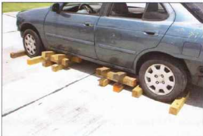
Imagen 17.44 Bloques han sido colocados en las ruedas del vehículo para prevenir el movimiento horizontal, y entarimados han sido usados para prevenir el movimiento vertical.
