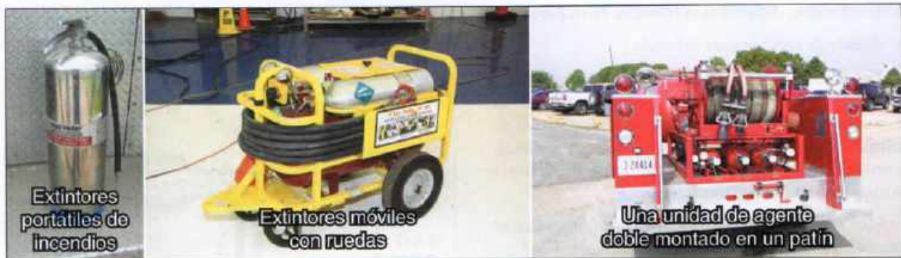
Imagen 18.10 El método de premezcla se usa comúnmente con extintores portátiles de incendios, extintores móviles con ruedas y sistemas de agente doble.
