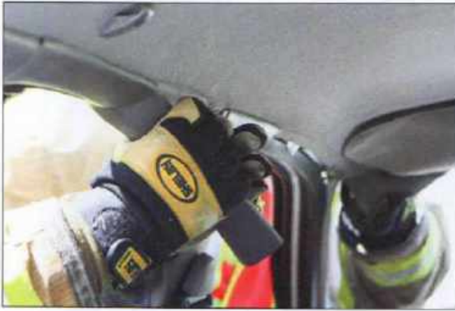
Imagen 17.37 Los rescatistas deberían quitar la moldura del interior del vehículo para ubicar los peligros del sistema de retención de seguridad dentro del compartimento de pasajeros.
