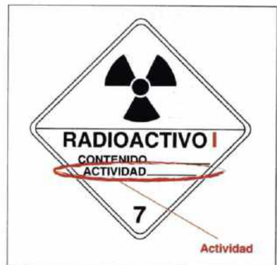
Imagen 24.40 Actividad se refiere al número de átomos en un material radiactivo que se desintegrarán y emitirán radiación en un segundo. Cuanto mayor sea el número, más radiación se emitirá.
