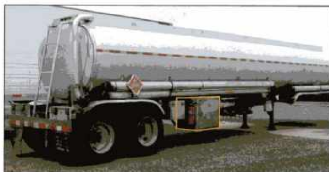
Imagen 24.138 Los camiones tanques de carga no presurizados pueden tener una caja de control de descarga debajo del tanque.
