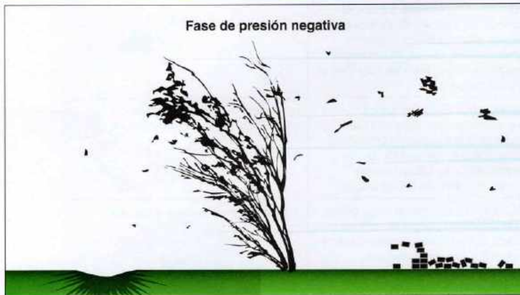
Imagen 24.184b Generalmente menos destructiva que la fase de presión positiva, durante la fase de presión negativa se pueden producir daños adicionales, particularmente en edificaciones y estructuras dañadas en la explosión inicial.
