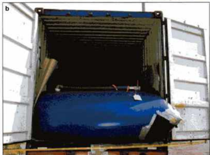
Imagen 24.90 a y b Los contenedores intermodales de carga pueden transportar materiales peligrosos en una variedad de embalajes. Los contenedores de carga no siempre están debidamente marcados. Cortesía de Barry Lindley.
