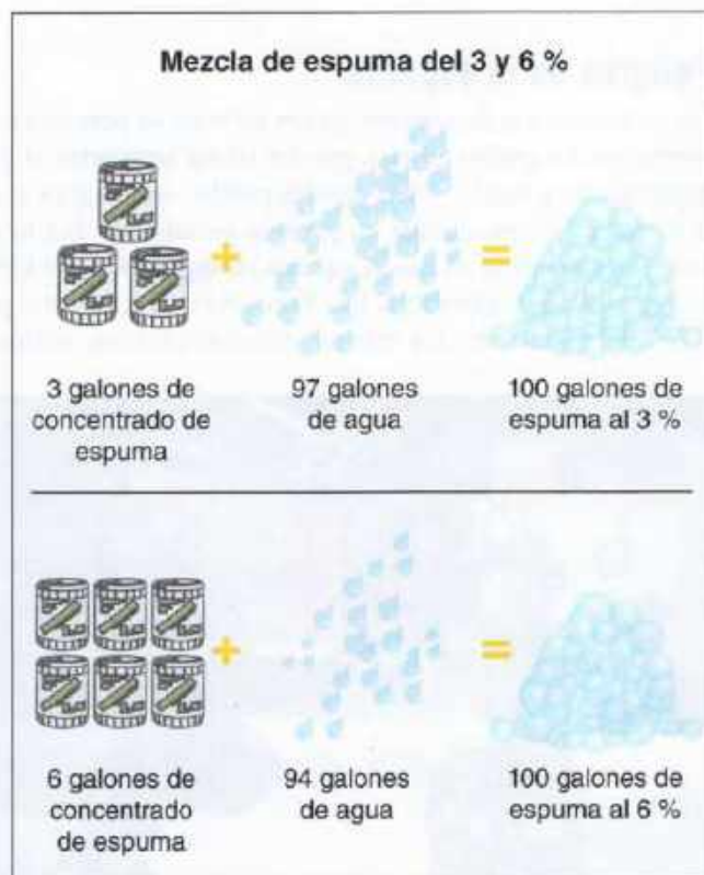
Imagen 18.7 Ilustración de las mezclas correctas de concentrados de espuma con agua al 3% y 6%.
