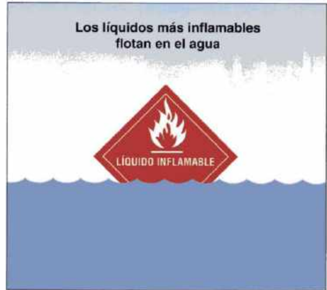
Imagen 24.25. El agua no es muy efectiva para apagar incendios de líquidos inflamables porque la mayoría de estos tienen gravedades específicas menores que el agua y flotarán hacia la superficie, donde continuarán ardiendo.
