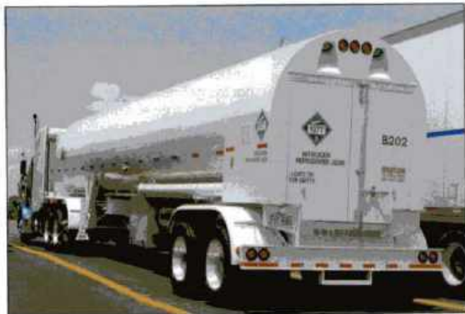
Imagen 24.124 Los camiones tanque criogénicos tienen una amplia gama de presiones, desde muy bajas hasta muy altas.
