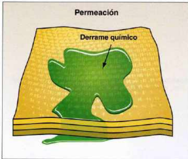
Imagen 26.21 La permeación ocurre cuando un químico pasa a nivel molecular a través de un tejido o material.
