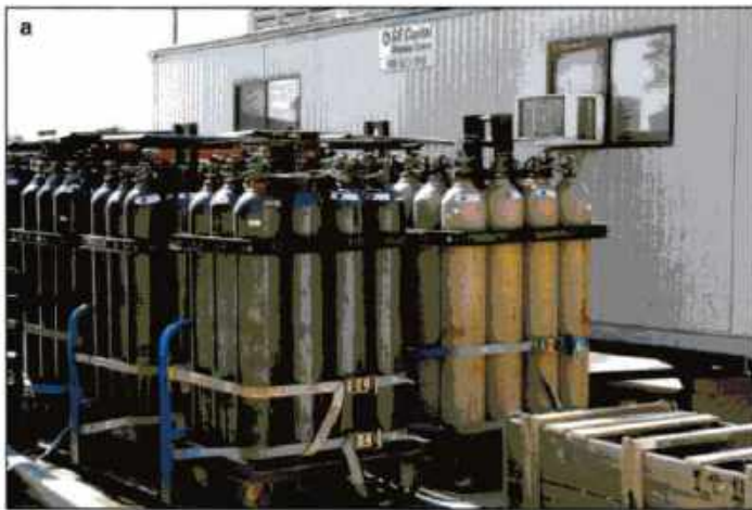
Imagen 24.186 a y b Los gases son transportados en (a) cilindros y (b) contenedores criogénicos.
