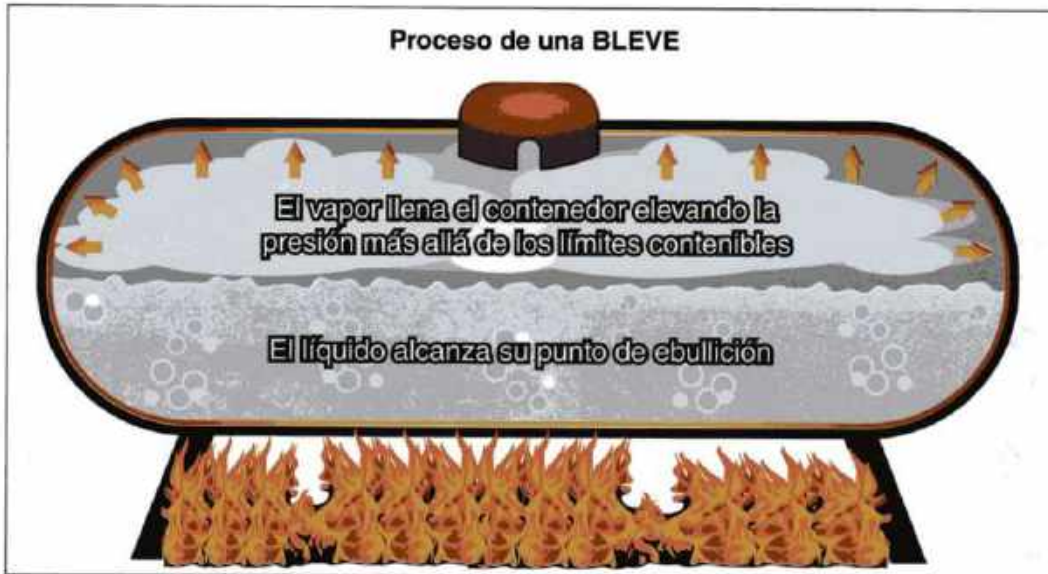
Imagen 24.94 Existe peligro de BLEVE siempre que los contenedores presurizados se expongan al calor durante un incidente, incluso si el contenido no es inflamable.
