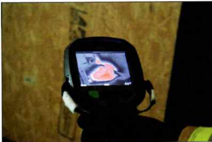
Imagen 15.6 Se pueden utilizar cámaras termográficas para identificar la localización de fuegos ocultos.
