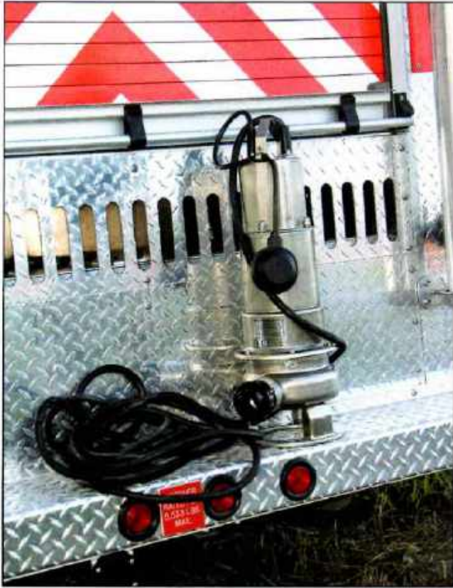
Imagen 15.14 Esta bomba sumergible puede utilizarse para extraer agua de sótanos u otros lugares dentro de una estructura.
