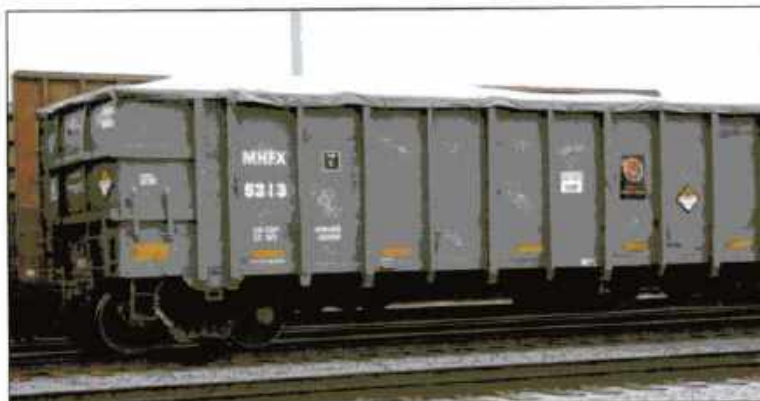
Imagen 24.152 Los contenedores de sólidos pueden estar cubiertos con lonas o dejados abiertos para exponer su contenido. Cortesía de David Alexander, Texas Commission on Fire Protection.
