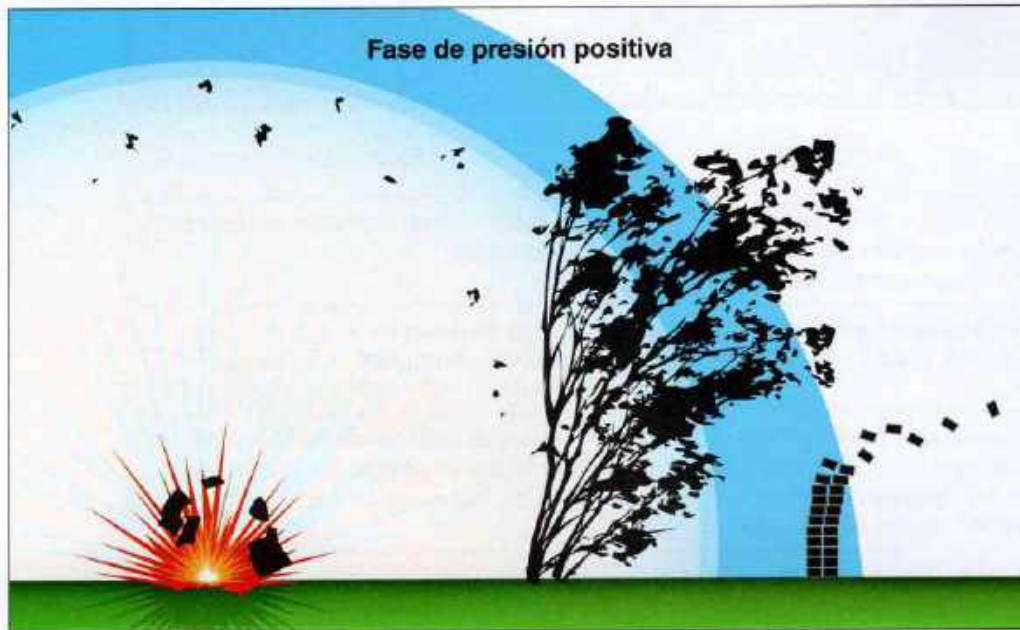
Imagen 24.184a La presión de una explosión comprimirá la atmósfera circundante en un frente de choque de rápida expansión. Dependiendo de su fuerza, esta onda de presión positiva puede ser extremadamente destructiva.
