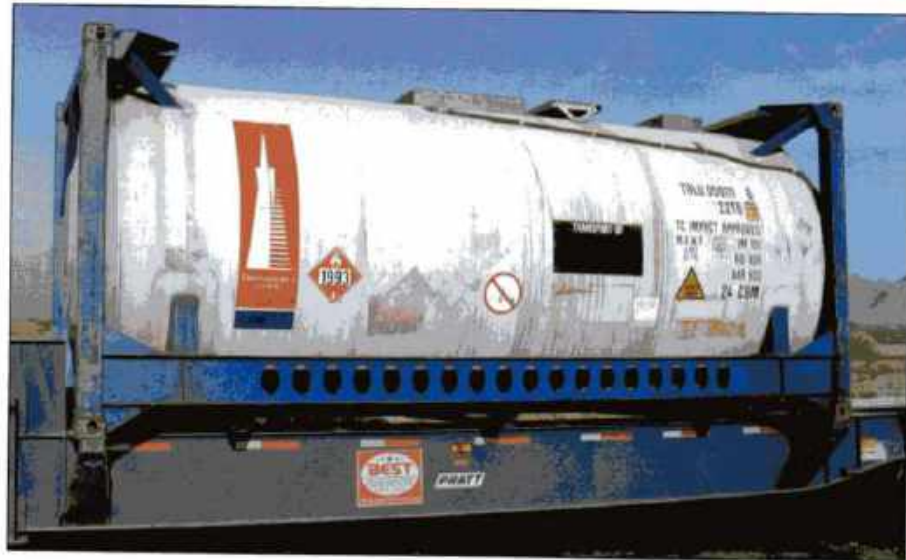
Imagen 24.150 Los tanques portátiles IM 101 transportan líquidos y sólidos peligrosos y no peligrosos. Cortesía de Rich Mahaney.
