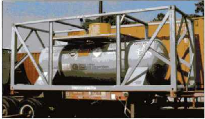
Imagen 24.89 Los contenedores tanques intermodales transportan materiales peligrosos en todo el mundo. Cortesía de Rich Mahaney.
