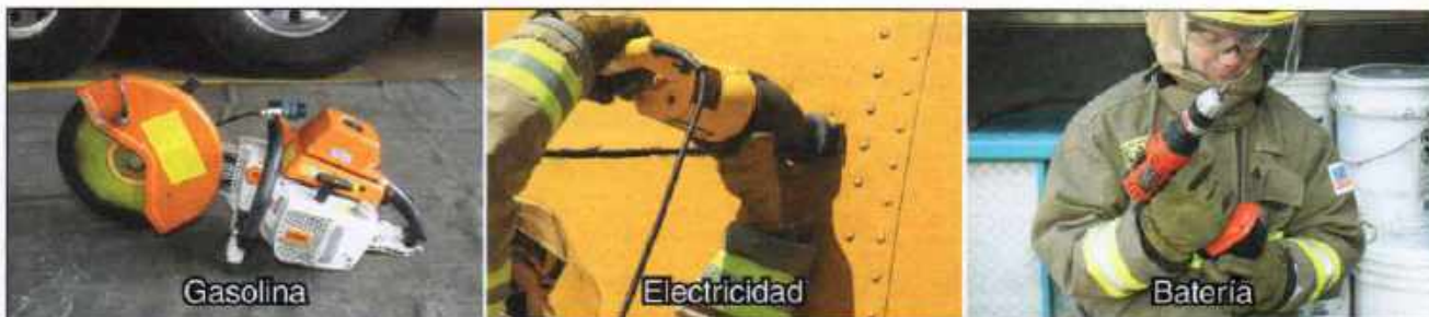
Imagen 17.24 Fuentes de poder comunes para herramientas de corte y perforación.
