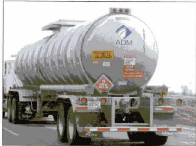
Imagen 24.135 Los anillos de refuerzo de este autotanque de baja presión son visibles. Cortesía de Rich Mahaney.
