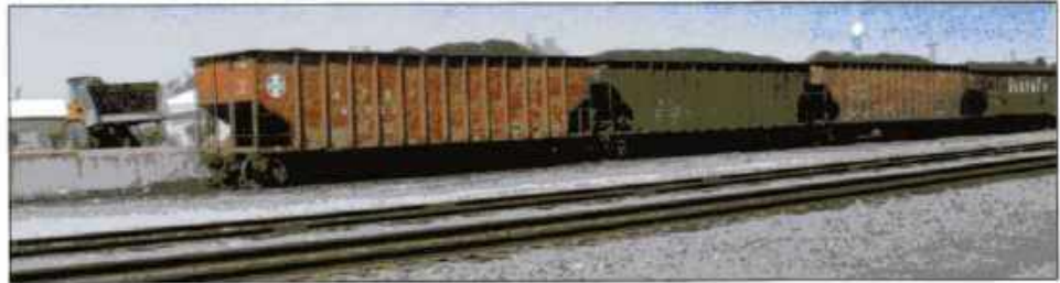
Imagen 24.155 Los remolques de carga seca a granel pueden tener compartimentos de descarga en la parte inferior en forma de V o W. Cortesía de Rich Mahaney.
