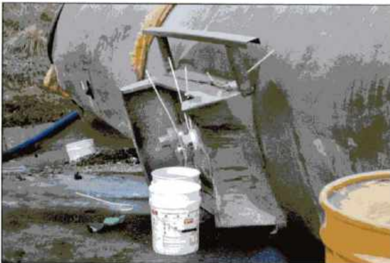
Imagen 24.136 Generalmente, los autotanques de químicos de baja presión están involucrados en derrames o fugas y no en roturas violentas. Cortesía de Barry Lindley.
