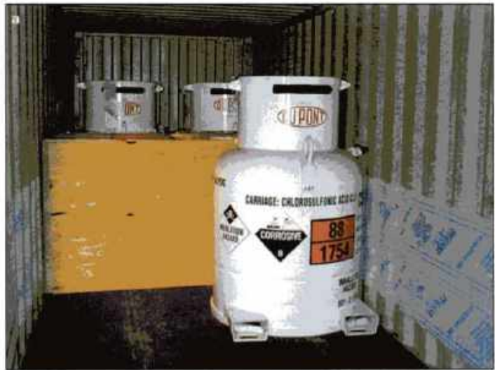
Imagen 24.89 Los contenedores tanques intermodales transportan materiales peligrosos en todo el mundo. Cortesía de Rich Mahaney.
