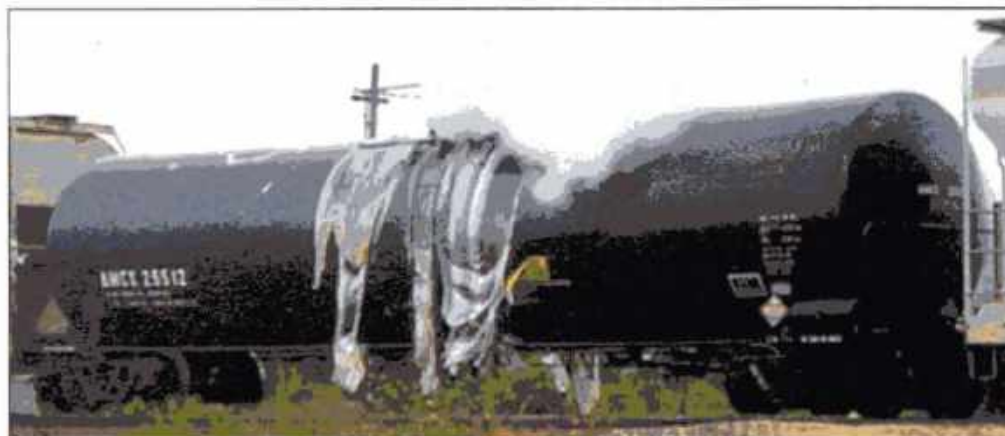
Imagen 24.36 El estireno puede volverse inestable y polimerizarse como resultado un de accidente. Cortesía de Barry Lindley.
