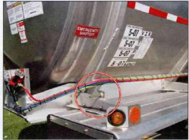
Imagen 26.61 Los tanques para químicos de baja presión tienen dispositivos de cierre en el tanque, detrás de la cabina, del lado del conductor. Cortesía de Rich Mahaney.
