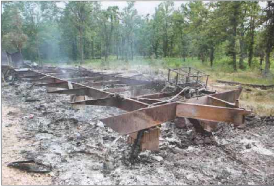
Imagen 20.12 Esta casa rodante resultó tan dañada que los investigadores tendrán dificultades para determinar la causa o el área de origen del incendio. Cortesía de Donny Howard, Agente, Oficina del Jefe de Bomberos del Estado de Oklahoma
