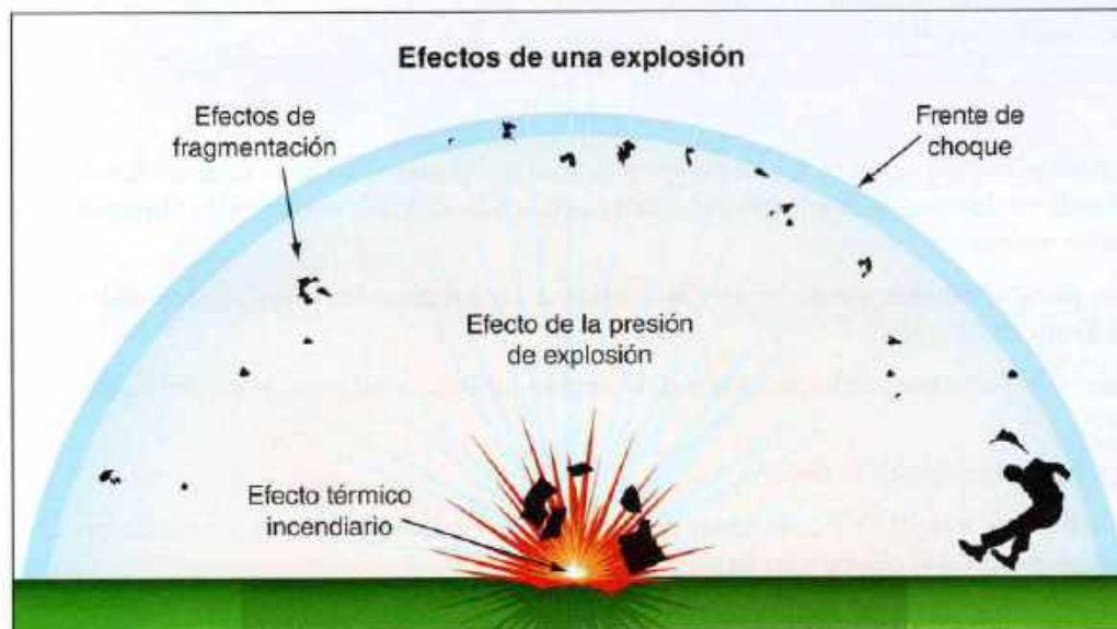
Imagen 24.184c Los efectos de una explosión incluyen el de presión de explosión, efectos térmicos/incendiarios, el frente de choque y el efecto de fragmentación.
