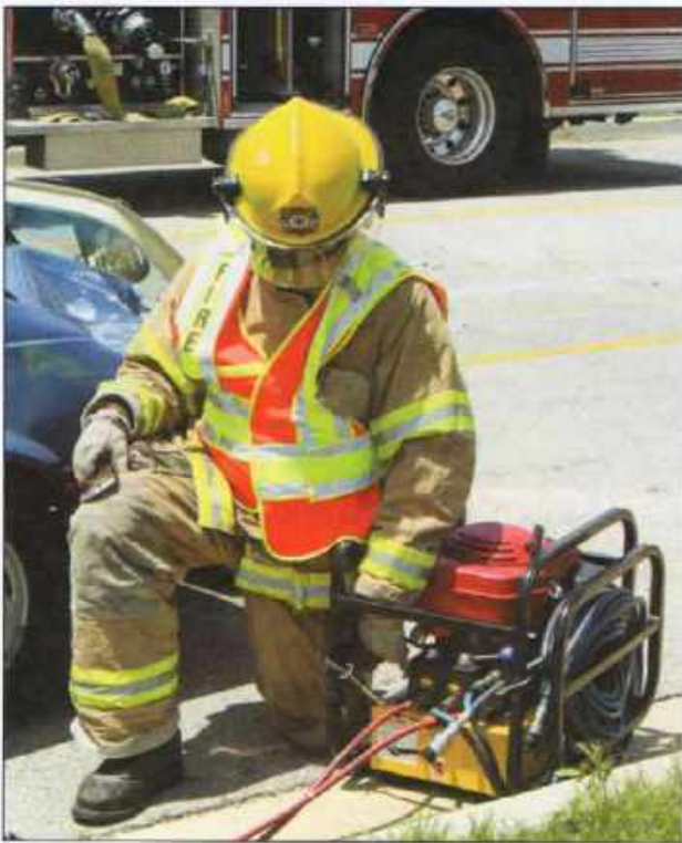
Imagen 17.16 Un bombero operando la bomba hidráulica de una herramienta de rescate que funciona con un motor a gasolina. Cortesía del Departamento de Bomberos de Owasso (OK).
