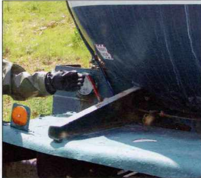
Imagen 26.59 Las ubicaciones de los dispositivos de cierre de emergencia de los tanques de carga varían. La mayor parte poseen uno, que se localiza directamente en el tanque, detrás de la cabina del lado del conductor. Algunos también tendrán uno en la parte de atrás del tanque.
