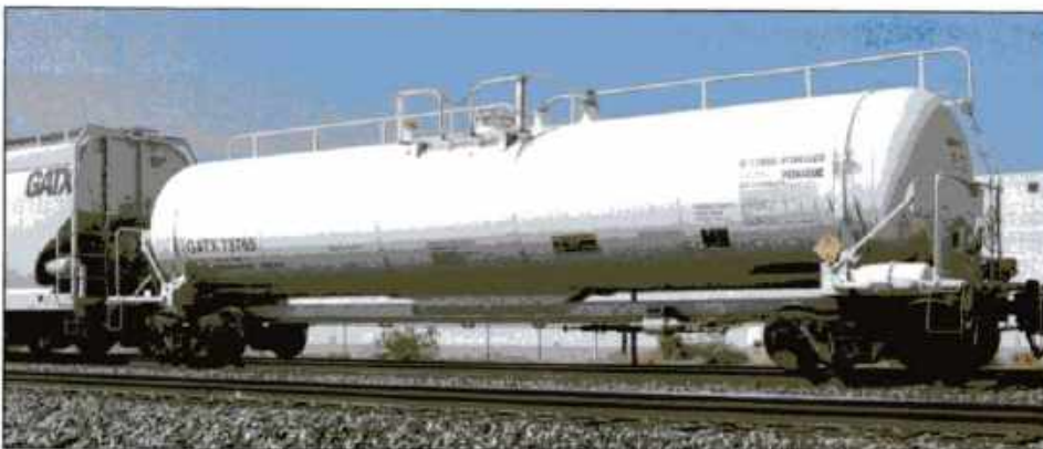
Imagen 24.144 Los oxidantes pueden ser transportados en carrotanques de baja presión. Cortesía de Rich Mahaney.
