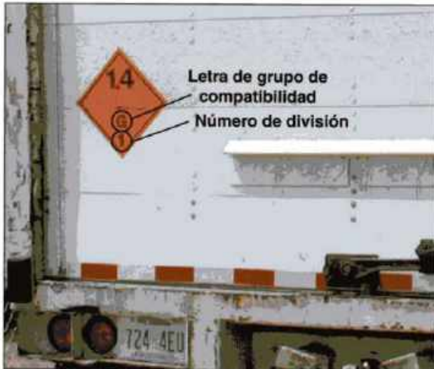
Imagen 24.182 Las placas para indicar materiales explosivos incluyen un número de división y una letra de grupo de compatibilidad. Este vehículo se utiliza para transportar fuegos artificiales. Cortesía de Rich Mahaney.
