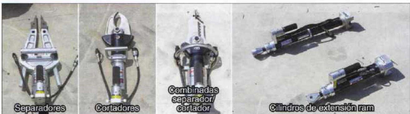
Imagen 17.23 Ejemplos de herramientas de rescate comunes con fuente de poder
