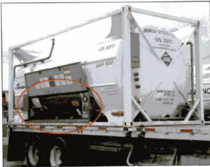
Imagen 24.121 Para facilitar su transporte los contenedores criogénicos pueden tener una estación de carga y descarga dentro de una caja incorporada. Cortesía de Rich Mahaney.
