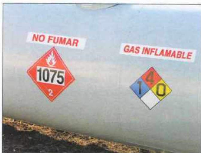
Imagen 18.16 Placas y rótulos que se pueden encontrar en un contenedor presurizado de gas inflamable. Cortesía de Rich Mahaney.
