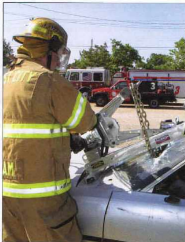
Imagen 17.53 Un rescatista que usa cadenas y un separador hidráulico para levantar la columna de dirección y el volante de una víctima.
