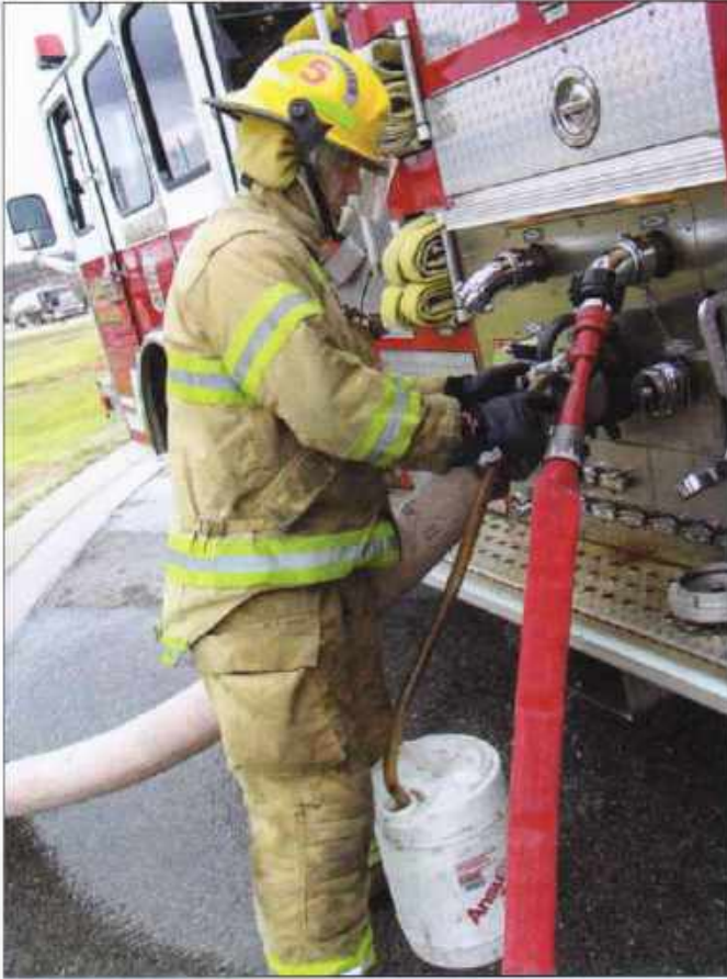
Imagen 18.11 Un bombero monitorea la operación de un eductor en línea durante una operación con espuma.
