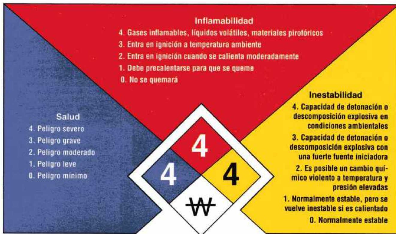
Imagen 24.204 Clave y diseño del sistema de identificación de peligros de NFPA 704.
