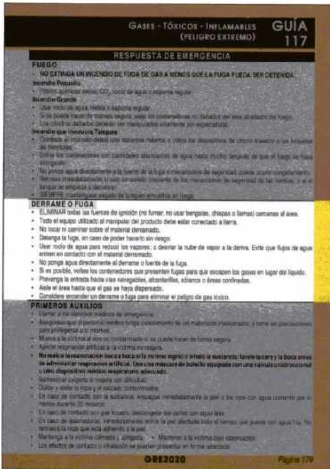
Imagen 24.224 La sección derrames o fugas señala las acciones a tomar para mitigar un derrame, así como los materiales a utilizar para absorberlo.
