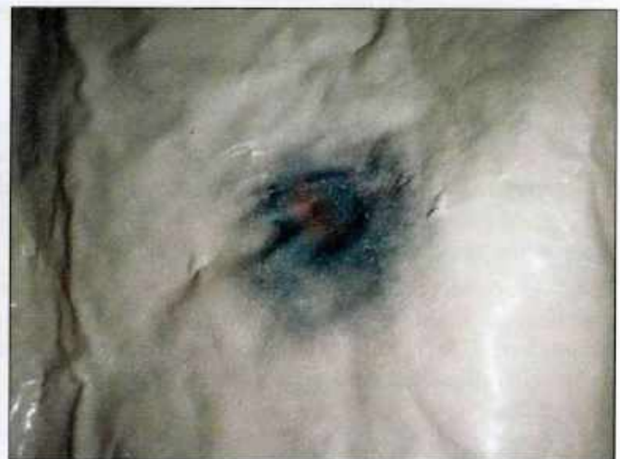
Imagen 26.22 a y b Una inspección rápida del exterior de este traje puede pasar por alto esta pequeña área de permeación (a). El daño es mucho más visible en el interior (b). Cortesía de Barry Lindley.
