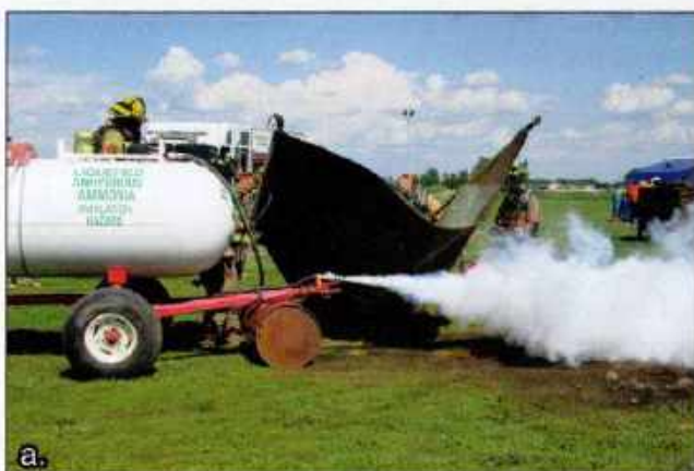
Imágenes 26.38 a y b Cubrir esta fuga de amoníaco anhidro hace que este se autorefrigere por debajo de la lona. Cortesía de Rich Mahaney.
