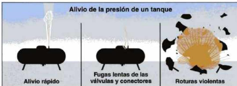
Imagen 24.101 Los contenedores presurizados liberan sus productos durante eventos de alivio rápido, fugas lentas desde válvulas y conectores, o roturas violentas.
