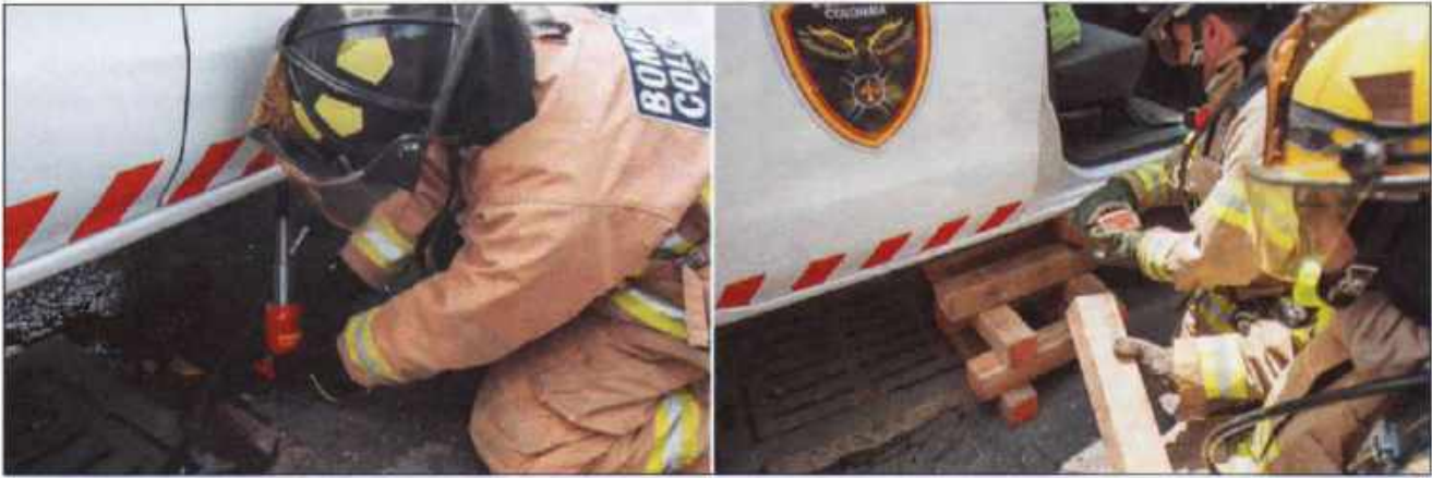
Imagen 17.18 Los gatos son herramientas de elevación útiles para operaciones de rescate. Cortesía Cuerpo de Bomberos Voluntarios de Bogotá, Colombia.
