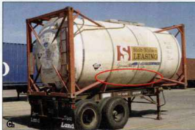
Imágenes 26.63 a-c Los contenedores intermodales de alta presión y criogénicos tienen dispositivos de cierre de emergencia. Busque un cable de metal que corre hacia la parte baja del riel del contenedor. Hale el cable para activar el dispositivo y cierre la válvula interna que se encuentra en el fondo del tanque. Cortesía de Rich Mahaney.
