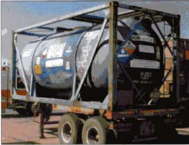
Imagen 24.114 Los contenedores intermodales presurizados no son muy comunes. También son conocidos como tanques Spec 51 o IMO Tipo 5. Cortesía de Rich Mahaney.
