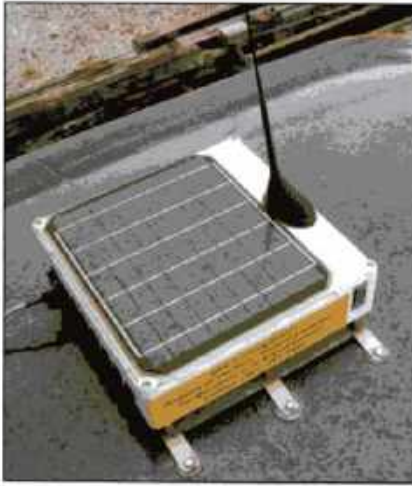
Imagen 24.112 Los carrotanques presurizados pueden estar equipados con dispositivos de rastreo por GPS. Cortesía de Rich Mahaney.
