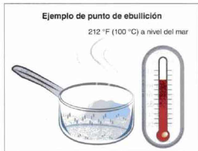
Imagen 24.20. Punto de ebullición es la temperatura a la cual un líquido hierve al nivel del mar. Los líquidos inflamables con bajo punto de ebullición son especialmente peligrosos porque se convierten en gas a temperaturas normales. Los líquidos con altos puntos de ebullición tienen que ser calentados antes de que comiencen a hervir.
