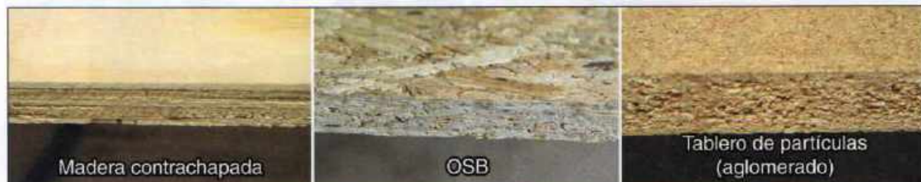
Imagen 16.15 Ilustración de las similitudes y diferencias entre tres productos comunes de madera de ingeniería.
