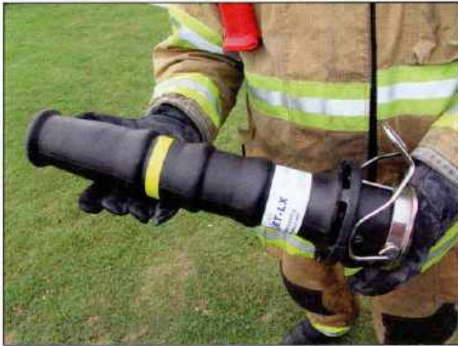
Imágenes 26.55 a y b Las boquillas con aspiración de aire, airean la espuma de mejor manera creando un mayor índice de expansión.
