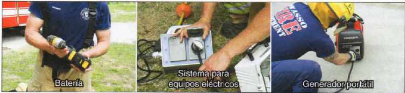
Imagen 17.15 Fuentes de energía eléctrica para herramientas y equipos de rescate.
