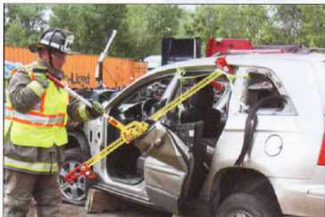
Imagen 17.19 Se usa un gato de palanca de trinquete ( high-lift ) para empujar la puerta de un automóvil fuera de posición.
