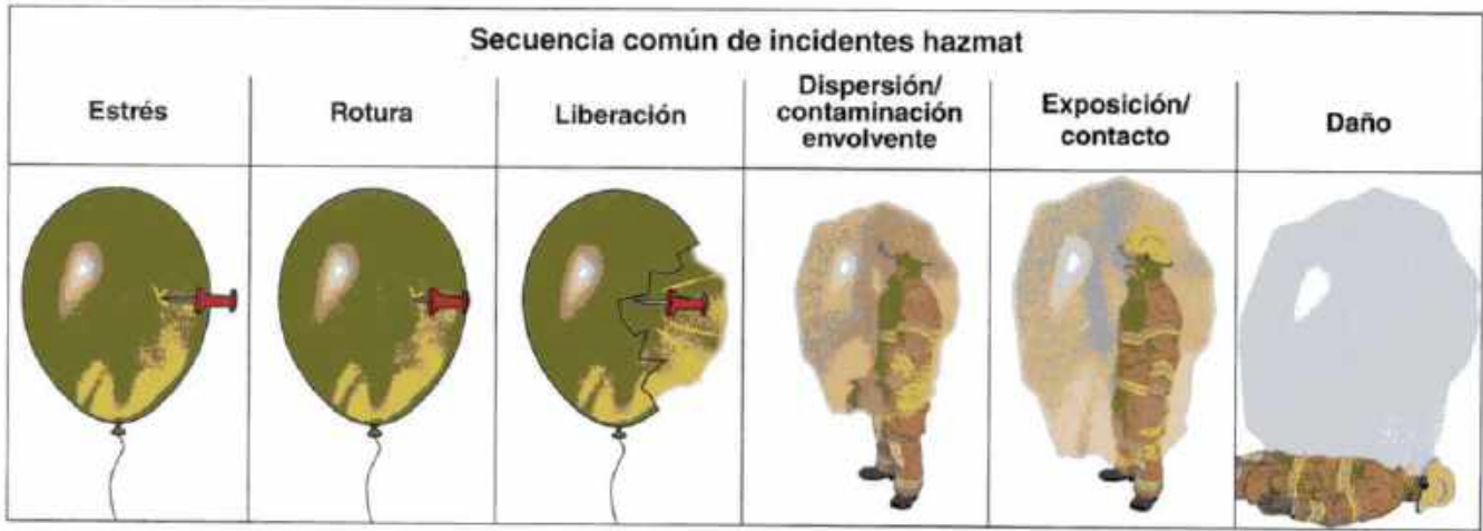
Imagen 24.50 La mayoría de los incidentes con materiales peligrosos siguen un patrón común.
