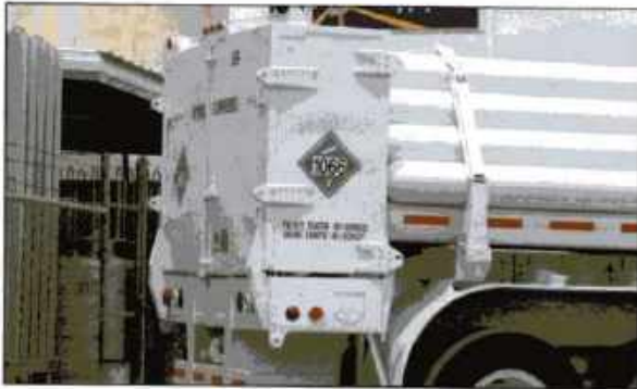
Imagen 24.107 Las válvulas de los cilindros en el remolque para cilindros de gas comprimido están protegidas en una carcasa en forma de caja. Cortesía de Rich Mahaney
