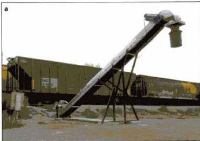
Imagen 24.151 a y b En el lugar hay sistemas para cargar y descargar materiales secos a granel procedentes de carrotaques. Cortesía de Rich Mahaney.
