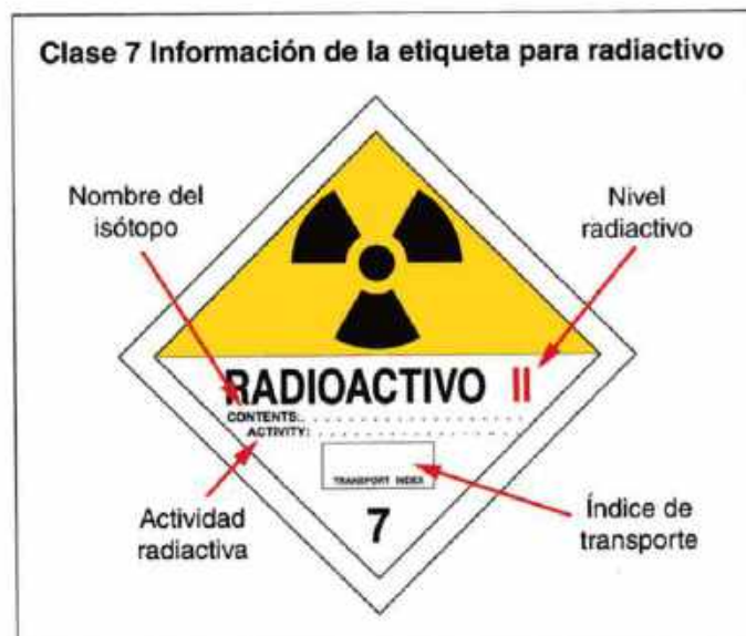
Imagen 24.197 Las etiquetas de la clase 7 siempre proporcionarán el nombre del isótopo, nivel de actividad, el índice de transporte y el nivel de radiactividad.
