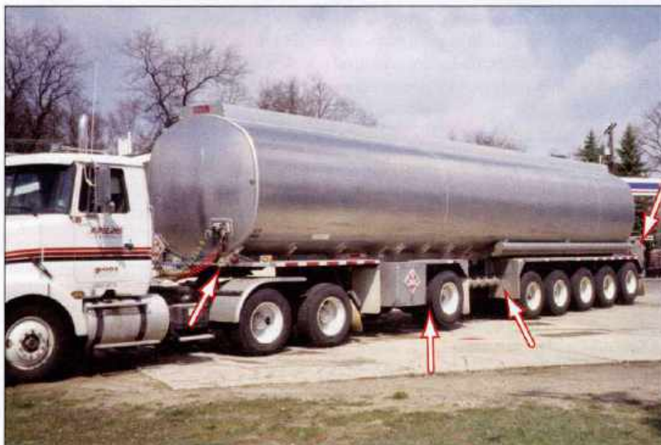
Imagen 26.62 Además de tener un cierre de emergencia en el tanque detrás del conductor, los tanques de líquidos sin presión pueden tener cierres adicionales ubicados en la parte trasera del tanque, en el centro del tanque cerca de las válvulas o en la caja de la válvula. Cortesía de Rich Mahaney.
