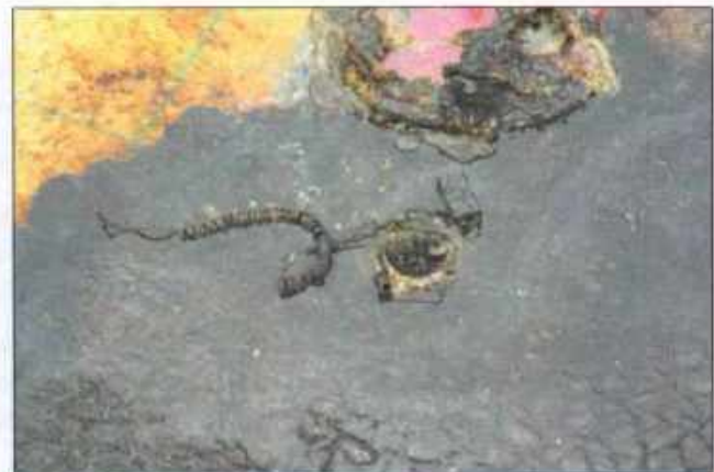
Imagen 20.21 Evidencia de un cronómetro y un contenedor de combustible de plástico encontrados durante una investigación de incendio.
