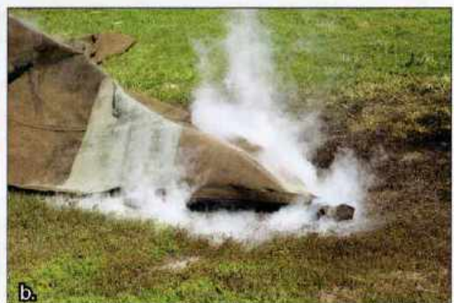
Imágenes 26.38 a y b Cubrir esta fuga de amoníaco anhidro hace que este se autorefrigere por debajo de la lona. Cortesía de Rich Mahaney.
