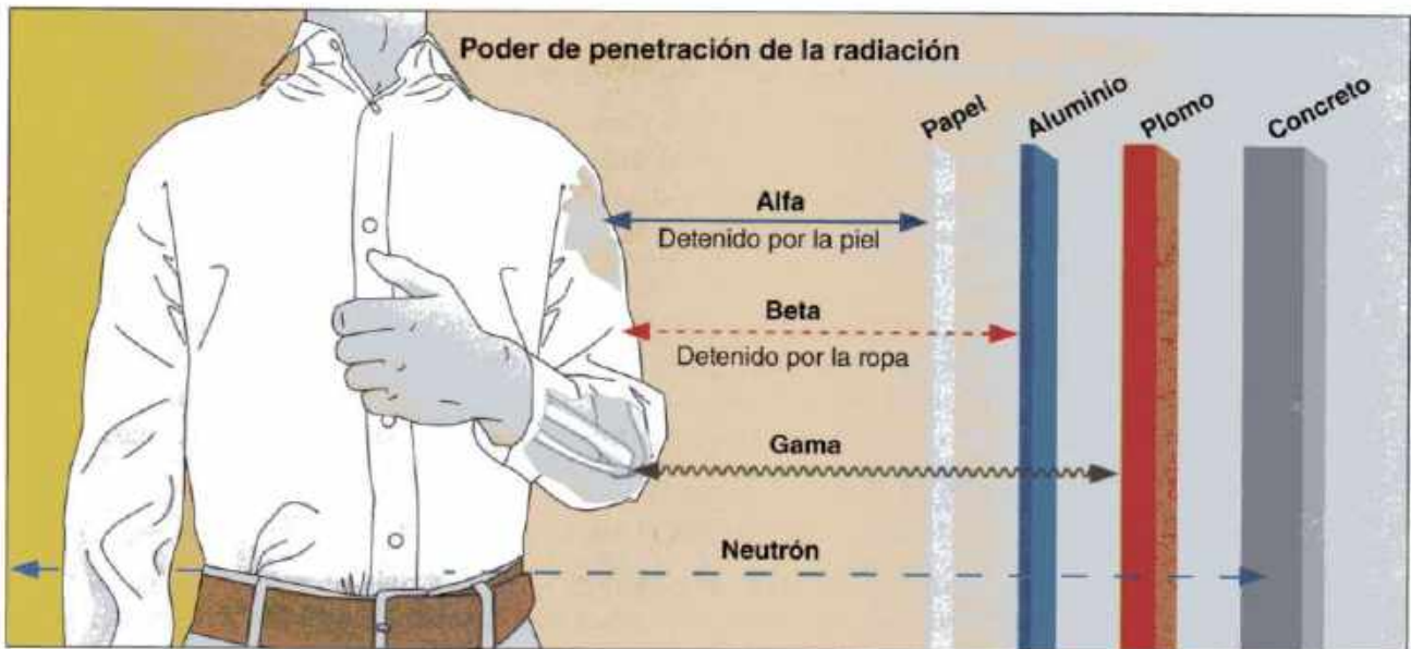
Imagen 24.38 Es muy difícil protegerse de la radiación de neutrones porque es altamente penetrante (CDC, 2015).
