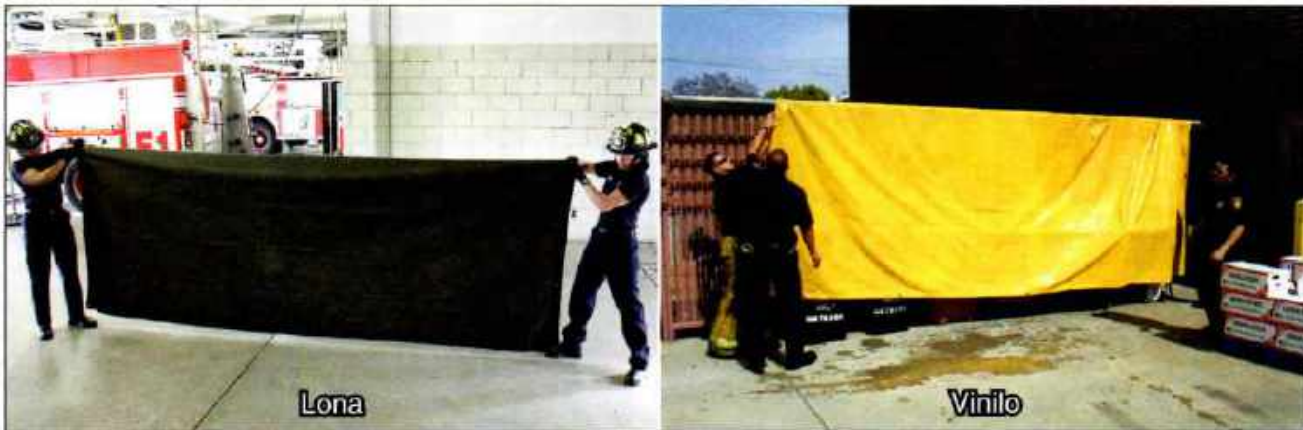
Imagen 15.10 Ejemplos de cubiertas de salvamento de lona y vinilo.
