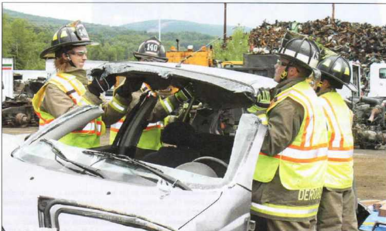
Imagen 17.50 Rescatistas quitando el techo del vehículo durante las operaciones de extricación.
