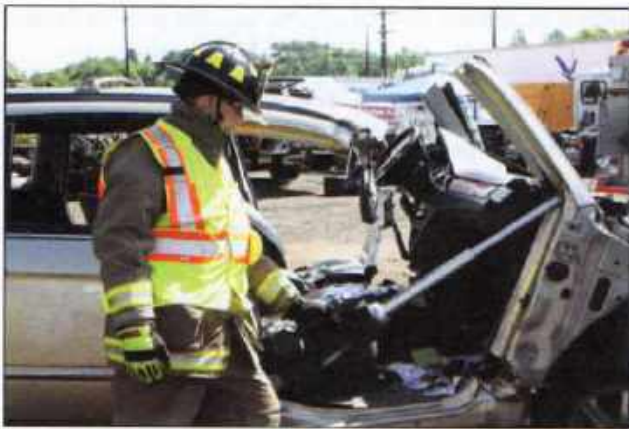
Imagen 17.52 Se puede usar un cilindro de extensión hidráulico ram para desplazar un tablero.
