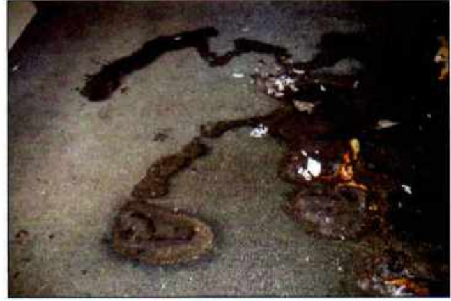
Imagen 15.34 Evidencia de remolques utilizados para propagar un incendio. Cortesía de Donny Howard.
