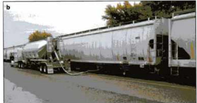
Imagen 24.151 a y b En el lugar hay sistemas para cargar y descargar materiales secos a granel procedentes de carrotaques. Cortesía de Rich Mahaney.
